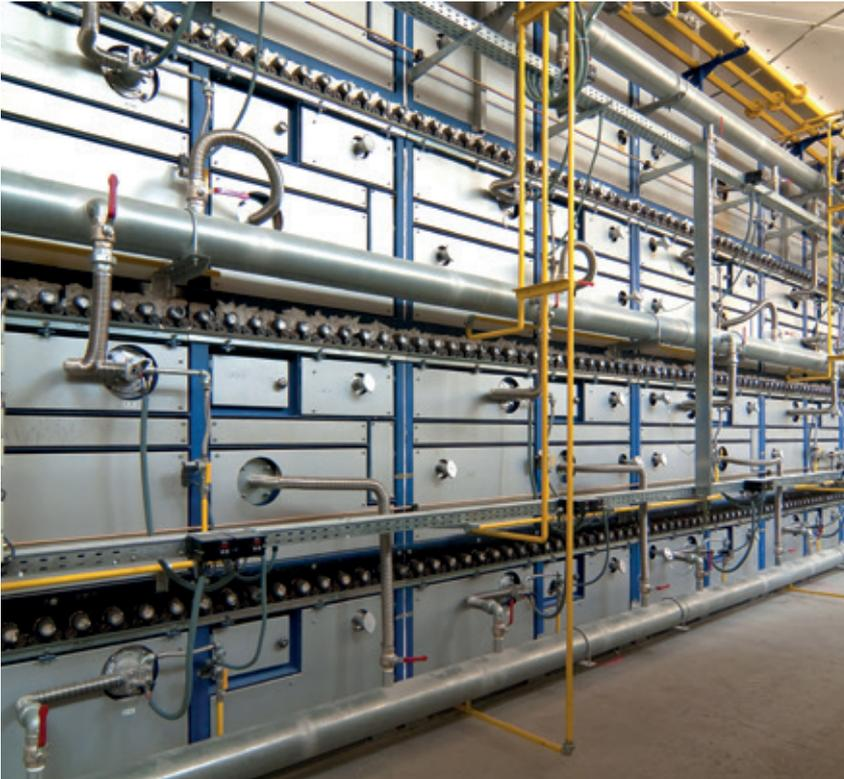
El horno cerámico es una unidad de producción flexible e innovadora en construcción modular prefabricada con revestimiento de ladrillos ligeros refractarios, y aislamiento térmico. Equipado con concepciones modernas de mando del horno y sistemas de seguimiento de vagonetas, el horno se usa para la primera cocción o cochura, la cochura de calor cerámica, la cochura bizcocho y la cochura de vidrio, dando un perfil de temperatura idóneo para el material cerámico.
