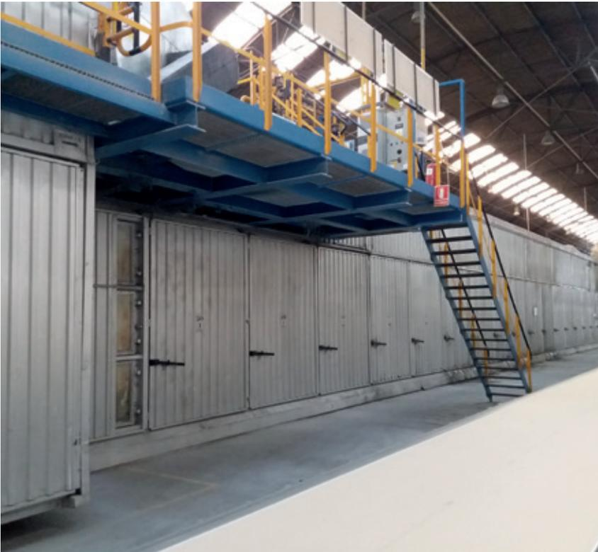
El Secadero, es parte de la línea de producción de la planta de Saint-Gobain Placo de Quinto en Zaragoza. La principal función del secadero consiste en retirar la humedad de las placas de yeso laminado mediante la incorporación de aire caliente y la extracción de aire húmedo, permitiendo que el material se vaya secando a lo largo de la línea por el interior de un túnel de longitud de 104 metros aprox.
