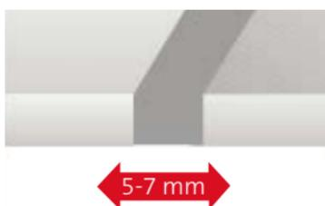
Antes de proceder al relleno de la junta aplicar una capa de Iberprimer en los cantos de las placas, a continuación rellenar completamente el interior de la junta con Pasta **Placo® PR Multi**, cerciorándose de que hace buen contacto con los laterales de la placa.
