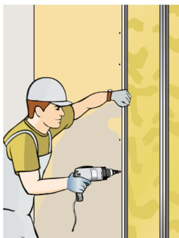
Las juntas de las placas de una cara del tabique nunca coincidirán con la de la otra. En los tabiques de dos o más placas, las juntas se alternarán realizándose en las capas interiores un tratamiento de juntas con acabado Q1.
