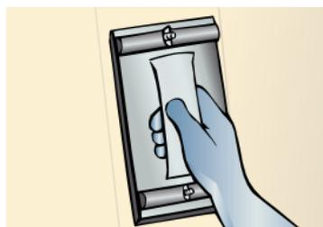
Para el tapado de las cabezas de los tornillos se utiliza la caja adecuada que a diferencia del tratamiento tradicional pasa a lo largo de todas las líneas de los tornillos de una manera continua.
