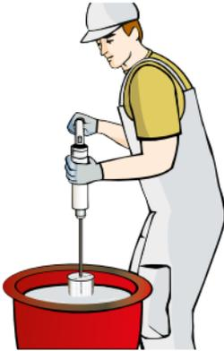
Se mezclará a mano enérgicamente hasta obtener la consistencia adecuada, si el mezclado es mecánico por medio de un batidor rotatorio este no sobrepasará las 380 rpm.
