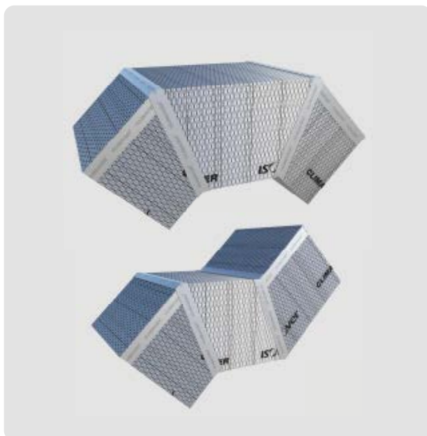
Figura Codo Método del Tramo Recto y Figura Desvío Método del Tramo Recto.
