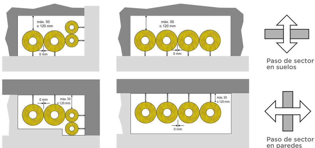
Las **U PROTECT Pipe Section Alu2** se pueden instalar con total seguridad incluso sin espacio libre, lo que significa que el aislamiento de las tuberías colindantes puede entrar en contacto y también puede tocar las aperturas del suelo y las paredes. Admite diversas configuraciones.
