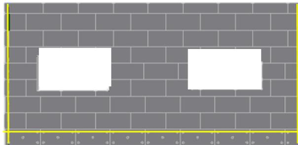
La combinación de hilos guía verticales y horizontales desde un punto a otro de la fachada genera un '*plano virtual*' que nos informará de la planicidad de la superficie de los paneles. El hilo guía horizontal, además, permitirá la correcta alineación de hiladas de paneles durante su colocación.
