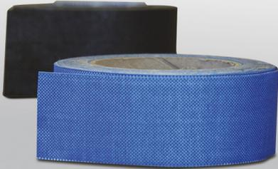
Cinta con el revestimiento exterior del complejo deco de 63 mm de ancho para la realización de conductos autoportantes CLIMAVER A2 Deco. Aseguran la estanqueidad del conducto y la perfecta adhesión de la cinta al conducto. Se aplica a temperaturas mayores de 0°C.
