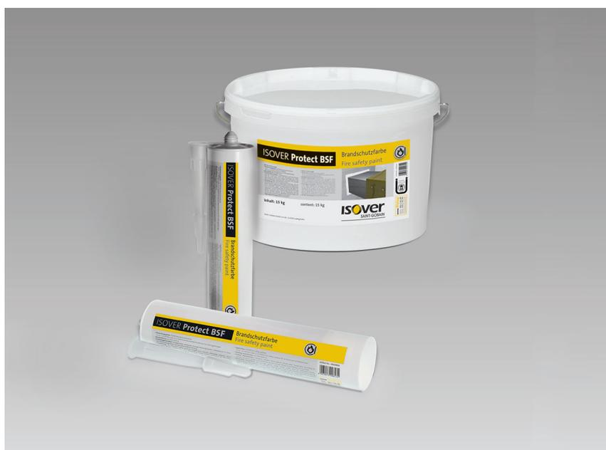
Produto intumescente de base aquosa, branco, com pH neutro e sem dissolventes. Nas paredes de passagem de condutas, é aplicado para isolamento ignífugo das chamas existentes entre a parede e a conduta.
