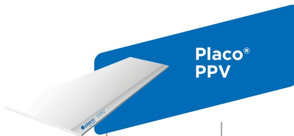
Placa de Yeso Laminado a la que se adhiere en su dorso una lámina de aluminio, obteniéndose una barrera de vapor en los trasdosados que evita las condensaciones intersticiales en los muros de fachada.
