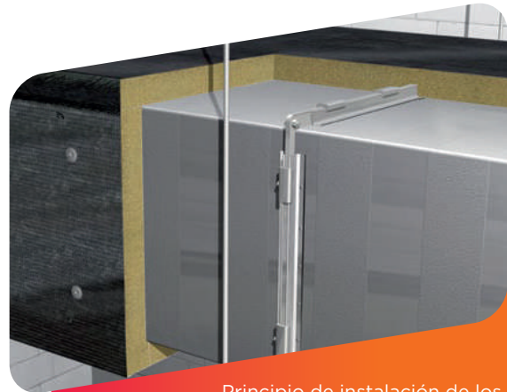
Principio de instalación de los conductos rectangulares horizontales
