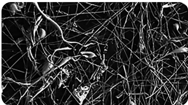
Microestructura de la lana de roca tradicional (25 % - 30 % de infundidos/ partículas no fibradas)
