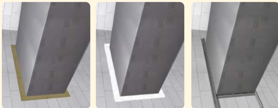
Figura 2: Sellado de penetración del forjado.
