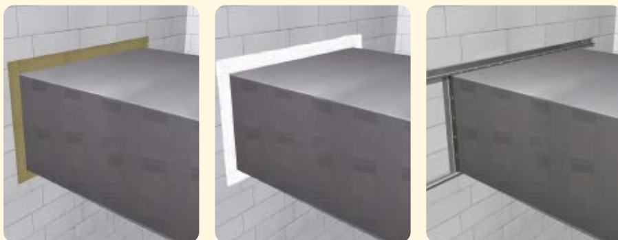
Figura 1: Sellado de penetración de la pared.
