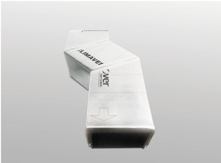
Panel rígido de Lana de Vidrio ISOVER de alta densidad, revestido por la cara exterior con una lámina de aluminio reforzada con papel kraft y malla de vidrio, que actúa como barrera de vapor, y por su cara interior, con un tejido neto de vidrio reforzado de color negro de gran resistencia mecánica.
